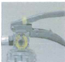
× 安全栓の脱落
