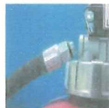
× 緊結ネジの破損 × ホースの脱落
