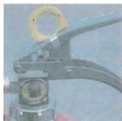
× 表示装置の脱落
